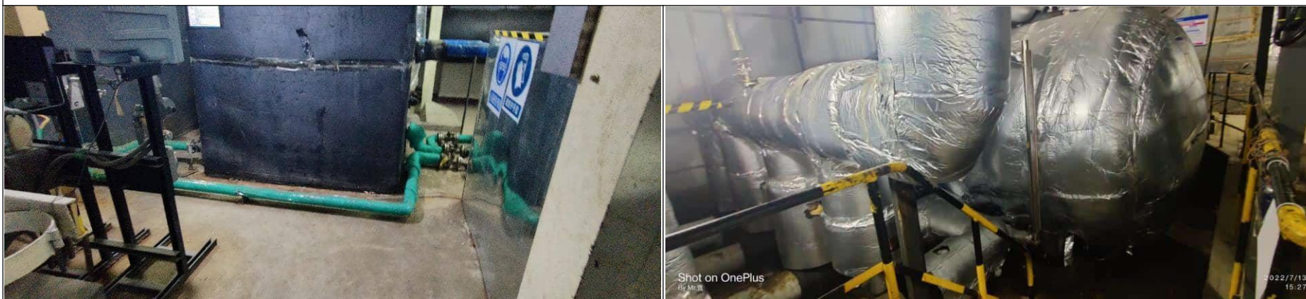
片基二部 1#线溶剂回收罐（不锈钢接地罐）
